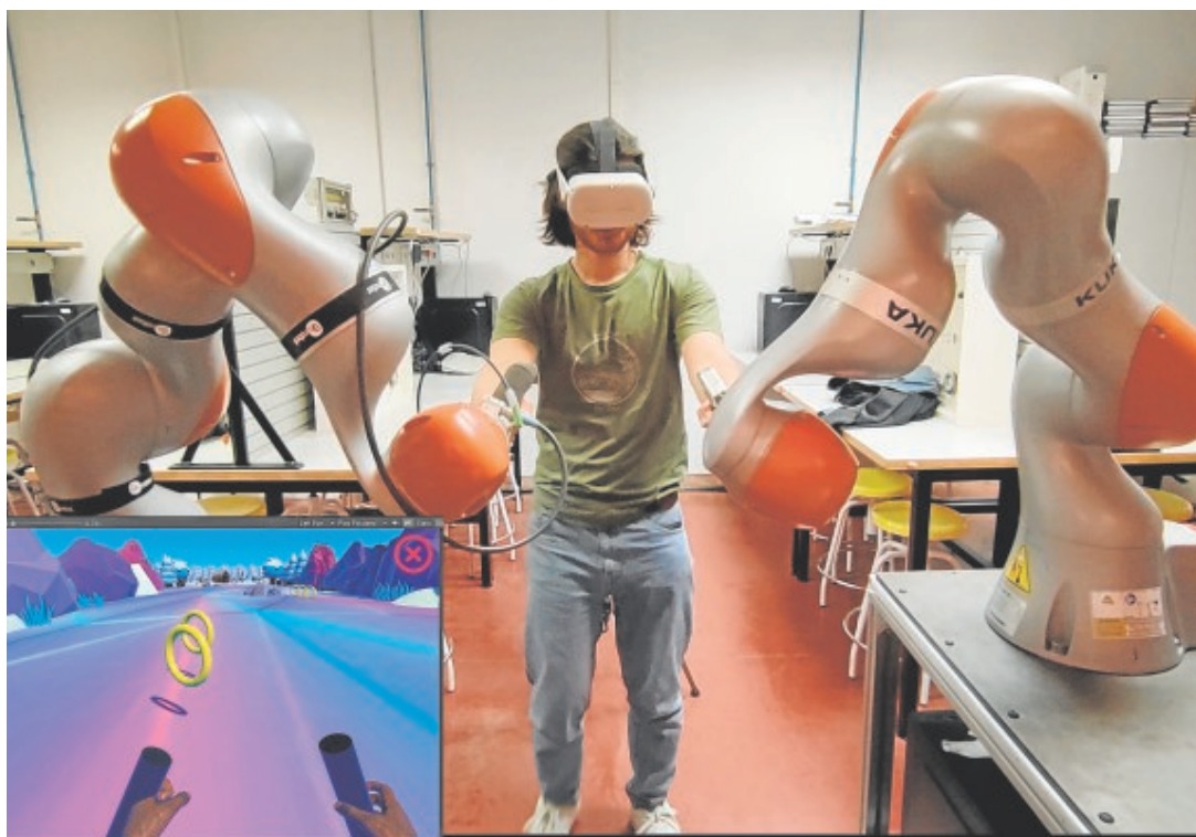
El robot colaborativo Roboasset cuenta con complementos como la gamificación a través de realidad virtual // UC3M
