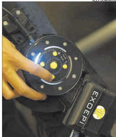
El sistema se adapta al pie y permite ajustar y controlar la fuerza que realiza a través de unos sensores.
