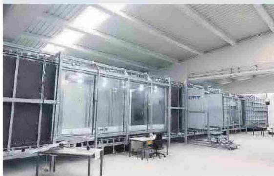
José María Desantes, director del CMT-Clean Mobility & Thermofluids, en el túnel de viento que servirá para probar la aerodinámica en elementos de ingeniería civil.
