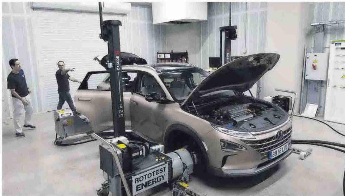
Una sala de pruebas que simula la circulación por la calle de un coche con energía de hidrógeno.
