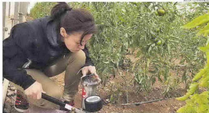
Seguimiento del estado hídrico para su ajuste en el programa de riego y ahorro energético.
