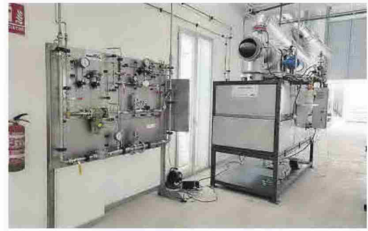
Cámara de combustión del ITC.
