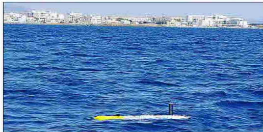
El dron submarino de la universidad en la bahía de Palma, donde también ha hecho mapeo de posición y fotogrametría de bajos y zonas peligrosas sumergidas.
