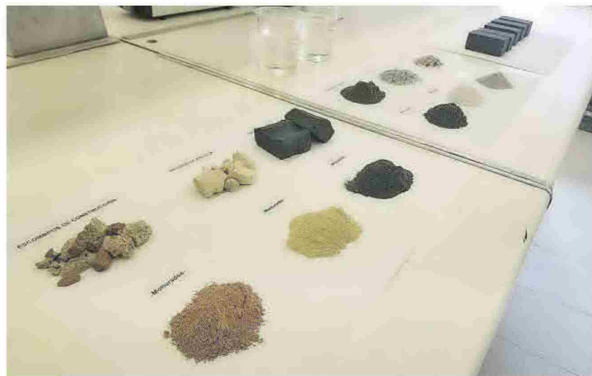
Residuos utilizados en nuevos ladrillos que evitan la cocción de los mismos.
