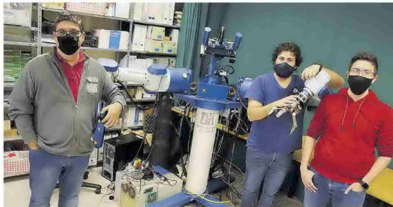
▶ Gustavo Casañ, Daniel Cardin y Marcos de la Cruz, con el robot 'Tombatosals', con brazos y sensores, capaz de tareas complejas como ver un objeto, cogerlo y manipularlo (abrir una botella o servir una copa), aunque no es móvil.
