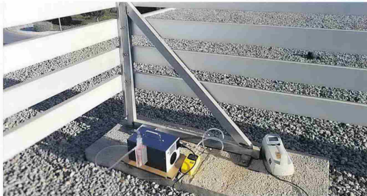
AVANCE. Equipos de medición de partículas finas y ultrafinas para monitorizar la calidad del aire en la ciudad.
