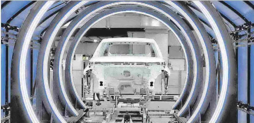
► **SISTEMA PARA DETECTAR IMPERFECCIONES DE LA UPV.** Mercedes y Volkswagen han instalado en sus fábricas de Vitoria y Pamplona, respectivamente, un túnel de inspección desarrollado por investigadores de la Universitat Politècnica de València (UPV) para detectar imperfecciones en las carrocerías de vehículos. Los túneles, como el que aparece en la imagen, se emplearán para inspeccionar el modelo Vito y el Clase V (de Mercedes), así como el Polo de Volkswagen.
