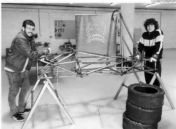
AVANZANDO. El equipo UJI Motorsport ya tiene listo el chasis tubular de su monoplace.
