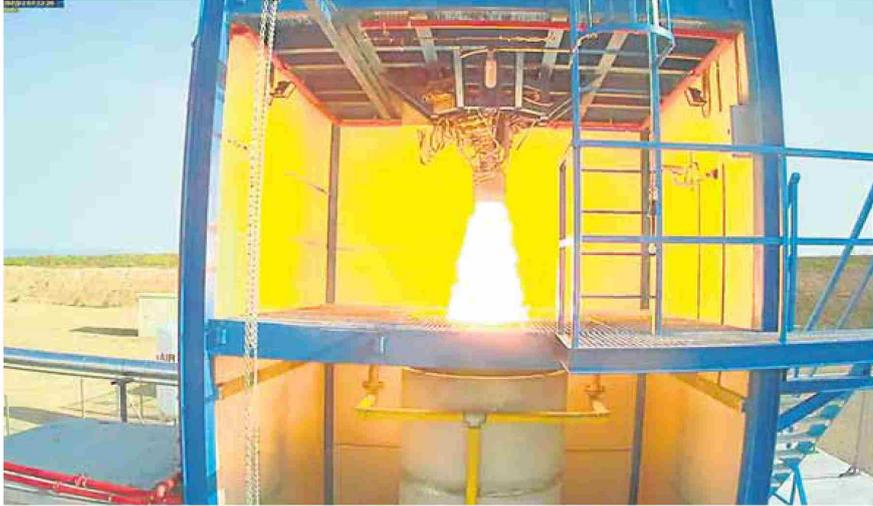
Prueba del motor de combustible líquido realizada en el aeropuerto de Teruel. :: R. A.
